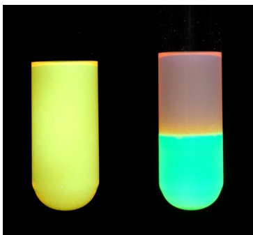
Abb. Links: Ethanol-Wasser-Gemisch versetzt mit Fluoreszenzfarbstoffen unter UV-Licht; rechts: dasselbe Gemisch nach dem Aussalzen mit Kaliumcarbonat unter UV-Licht.
