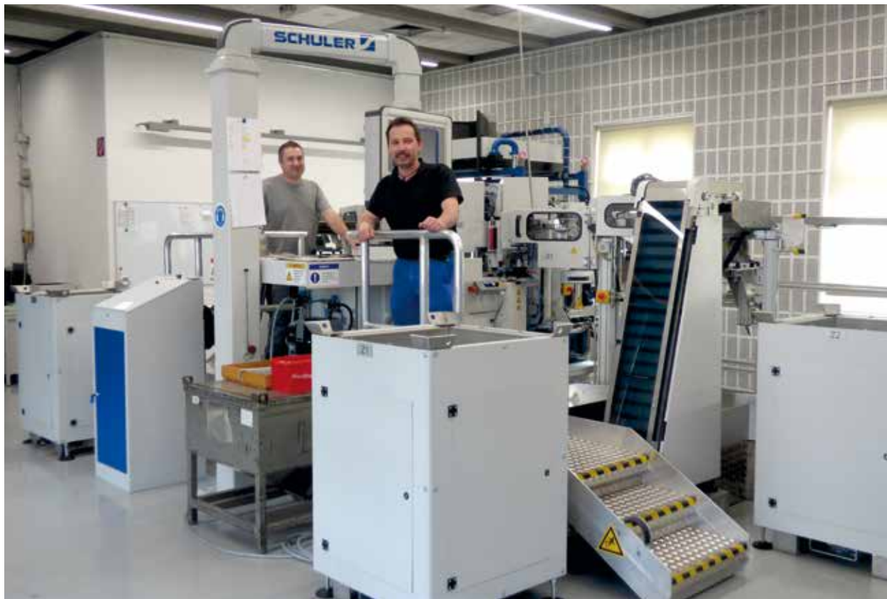
Die Münzmitarbeiter Thomas Kremer und Karsten Mohr auf der Fügemaschine auf der die Rohlinge für die Polymermünze zusammengefügt werden. Eine weitere Maschine gibt es nur beim Bayerischen Hauptmünzamt in München
