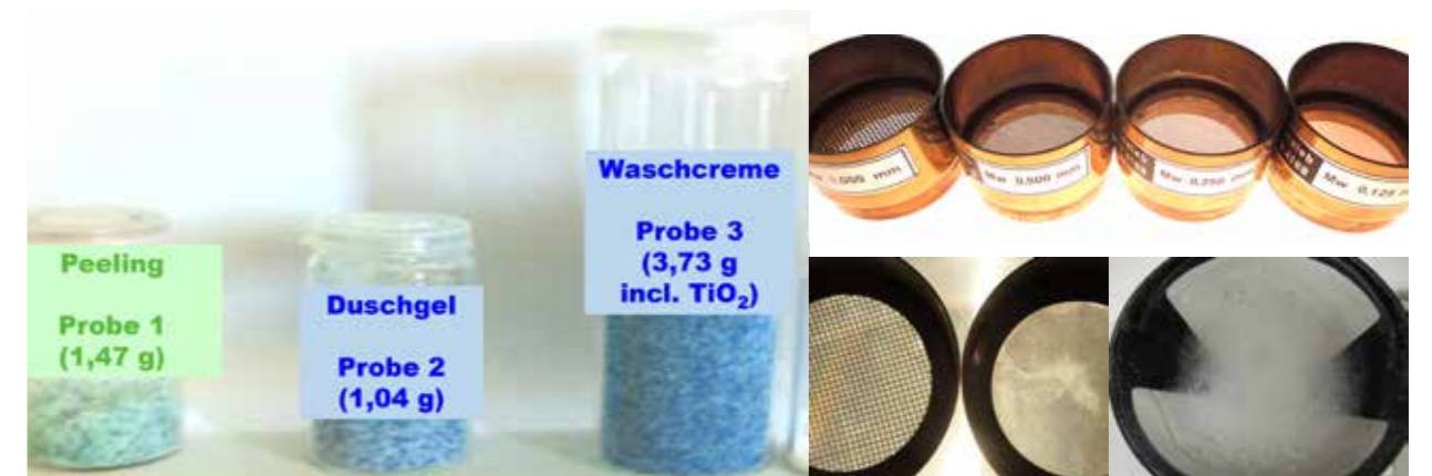
ABB.4 „AUSBEUTE“ AN MIKROPLASTIK AUS KOSMETIKPROBEN NACH STOFFTRENnung MIT GEEIGNETEN ENGMASCHIGEN SIEBEN
