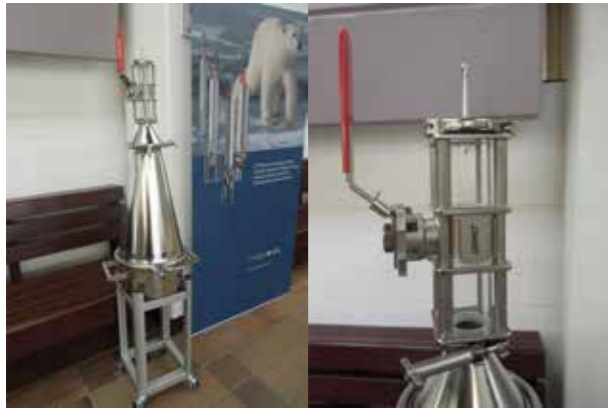
ABB. 11 MIKROPLASTIK-SEDIMENT-SEPARATOR (MPSS) DER KIELER FA. HYDROBIOS
