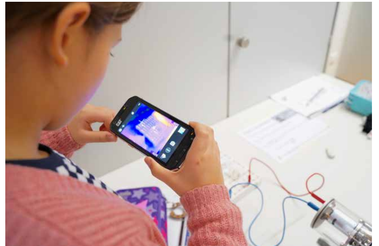
Fast immer, wenn in der Physik Energie übertragen wird, entsteht Wärme. Eine Schülerin untersucht hier mit einer speziellen Kamera, wie sich bei der Übertragung von Energie in einen elektrischen Stromkreis die Kabel erwärmen.
